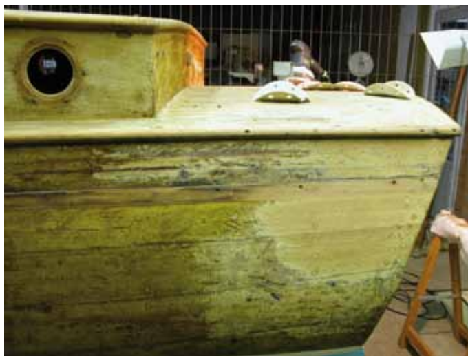
DE BOOT WERD VOLLEDIG ONTMANTELD, OP ZIJN KOP GEZET EN VANAF DE KIEL TERUG GERESTAUREERD.
