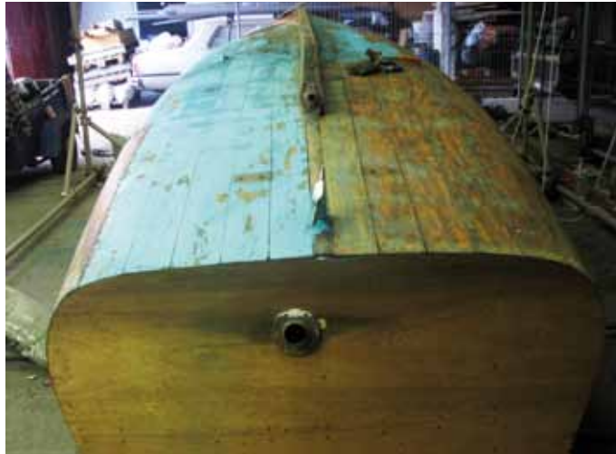
DE BOOT WERD VOLLEDIG ONTMANTELD, OP ZIJN KOP GEZET EN VANAF DE KIEL TERUG GERESTAUREERD.
